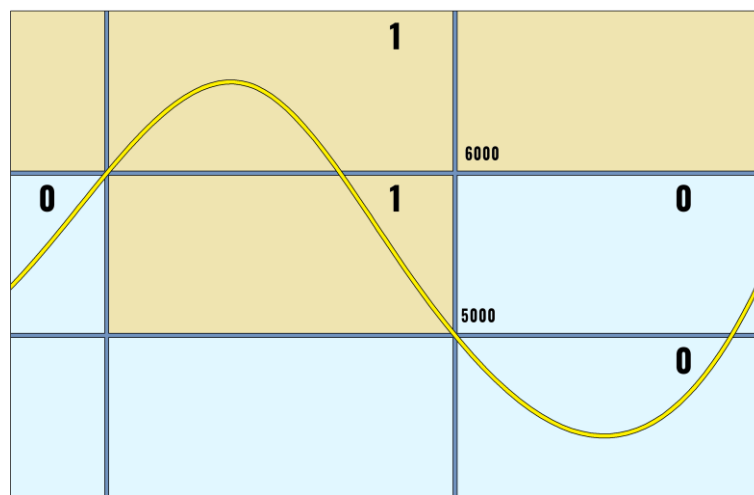
Рисунок 2.14 Преобразование аналогового сигнала в дискретный
